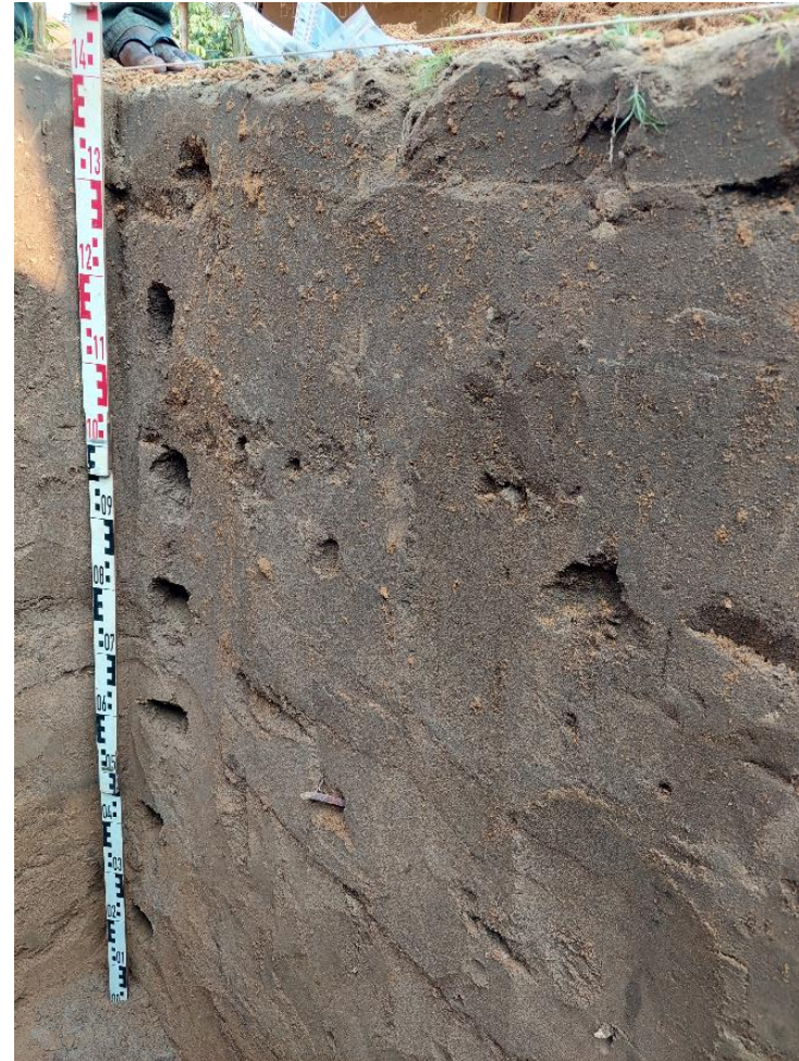
Tranchée d'excavation avec prélèvement d'échantillons de sol.
